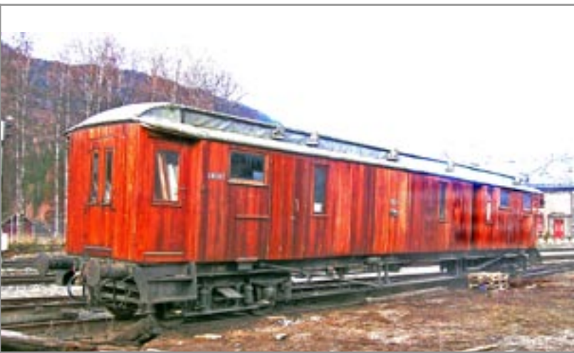
Til høyre er vognen fotografert på Fåberg 31/10. I påvente av transporten har Maihaugens håndverkere videreført arbeidet med den utvendige restaureringen, og den vognsiden vi ser her er praktisk talt ferdig.
