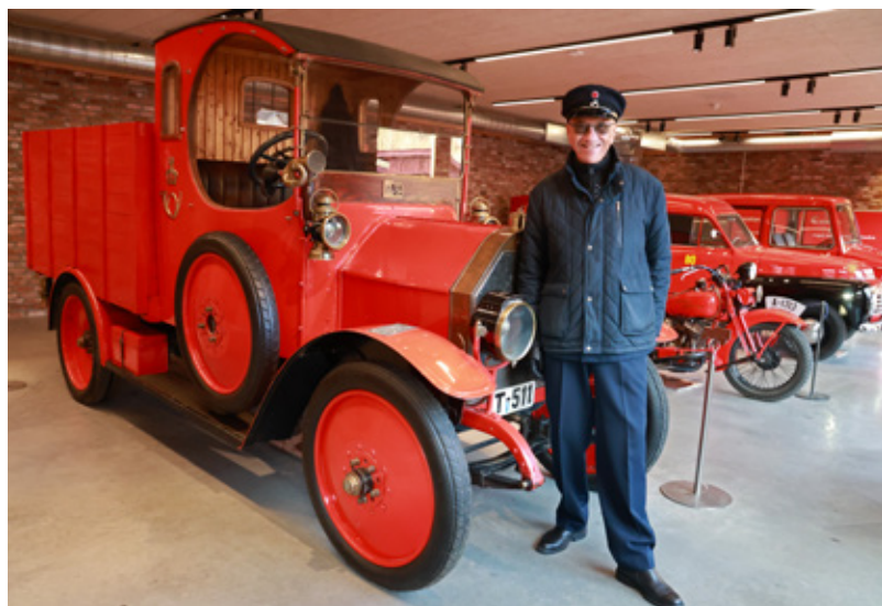
KJØRETØYENE. Setten er stolt av alle de gamle og flotte kjøretøyene ved museet som tidligere er brukt i postarbeid. Den flotteste av dem alle er Norges eldste kjørbare lastebil – en Fiat Ter Lorry 1914-modell. Denne ble brukt ved Kristiansund postkontor fra 1920 fram til ca. 1932.
