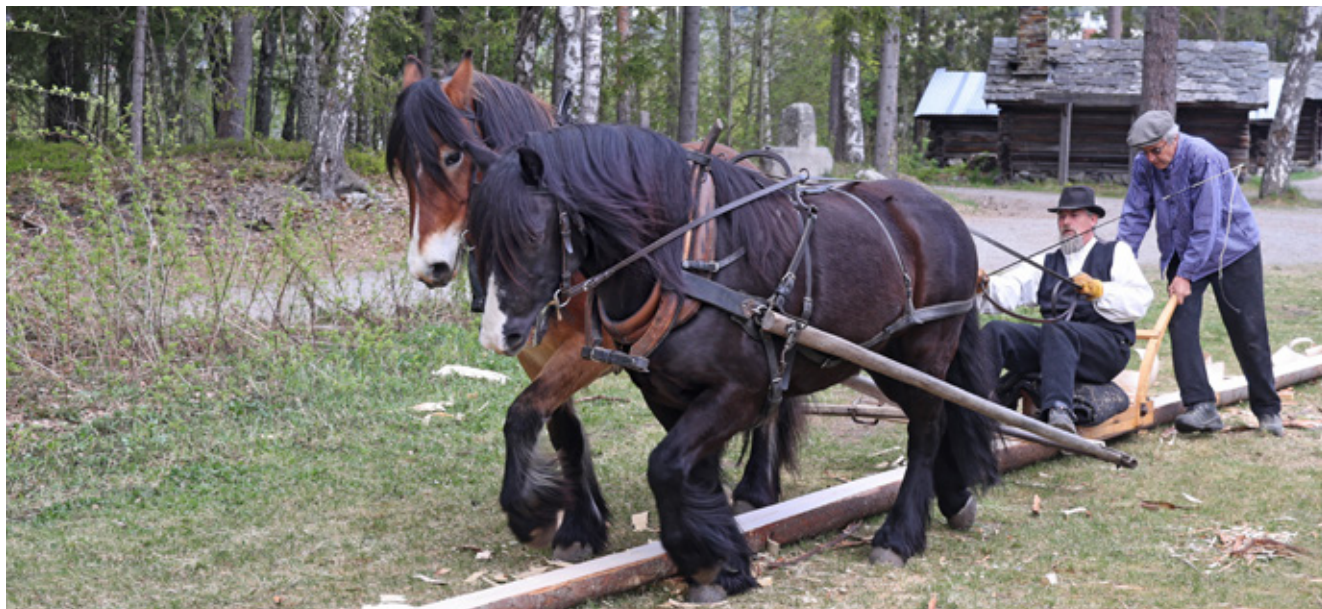
Høvling av takflis er tungt arbeid. Her ser vi de to hestene på Maihaugen, Herman og Maihauggutten bakerst, må ta skikkelig i for å trekke høvelen.
