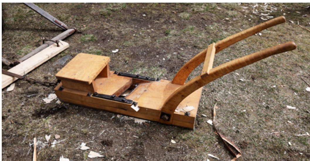
Høvling av takflis er tungt arbeid. Her ser vi de to hestene på Maihaugen, Herman og Maihauggutten bakerst, må ta skikkelig i for å trekke høvelen.
